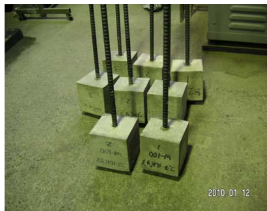
写真-2 付着強度試験被検体
