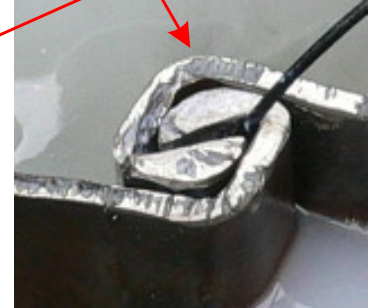
写真2 高粘性ポンプと空洞と見立てた鋼矢板&注入
