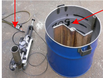
写真2 高粘性ポンプと空洞と見立てた鋼矢板&注入
