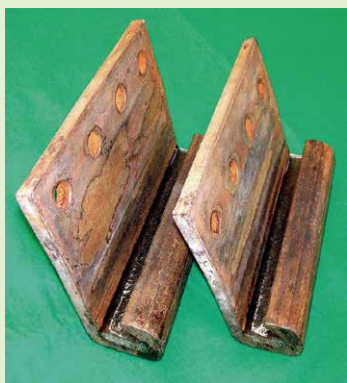
写真-15 パイルロックNS-vを塗布した継手
