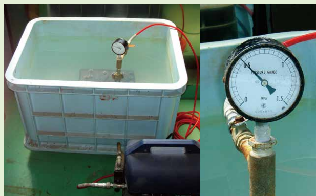
写真-17 耐圧試験の様子
