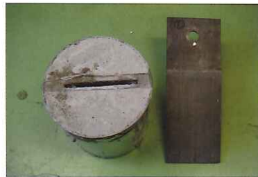
フラットバーと引き抜き跡
